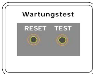
Das gleichzeitige Drücken der Tasten **"TEST"** und **"RESET"** für 5 Sekunden aktiviert den Wartungsmodus.
