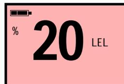
Das rot leuchtende Display zeigt die Gaskonzentration in UEG an. Mit steigender Konzentration nimmt die Frequenz des akustischen Signals zu.
