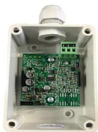
Sonde mit demontiertem Sensor
