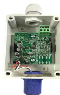
Sonde mit neu montiertem Sensor
