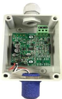
Sonde mit zu ersetzendem Sensor
